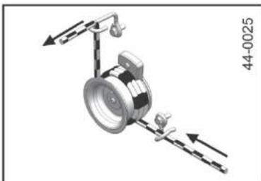
这个标签放在绞磨机外壳上。它指示便携式绞磨机的牵引绳安装方向。
